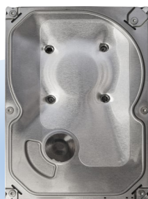
HDD 4穴穿孔破壊
